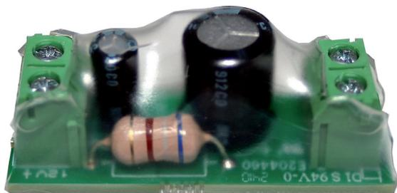
Circuit imprimé sous gaine thermo rétractable.
